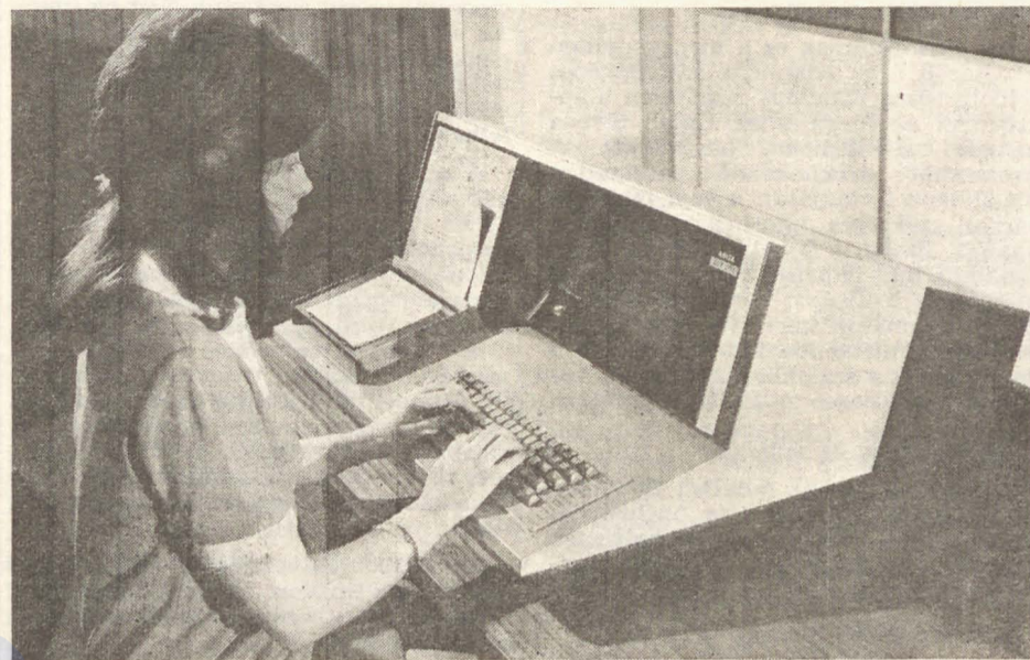
A Lamson Viatron Computer Systems Ltd. cég ANITA DET 3111 típusjelű adatbe- viteli berendezése. A billentyűzött adatok először képernyőn jelennek meg, majd mágnesszalagra rögzíti azokat.
