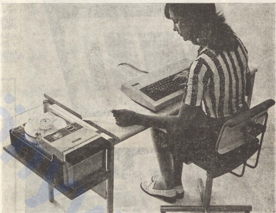
A svéd Facit cég 6205 típusú lyukszalagos adatrögzítő berendezését speciálisan fényesedőgépekhez fejlesztették ki.
