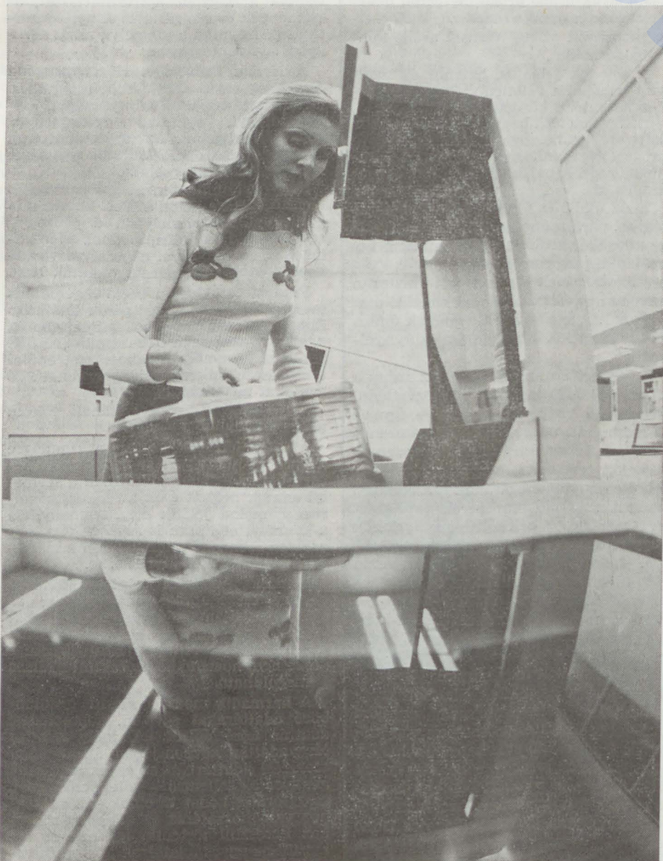
Az angol ICL legújabb 2900-as számítógépcsaládjának cserélhető mágneslemez egysége. Kétféle változatban készül 100 és 200 Mbyte tárolókapacitással.
