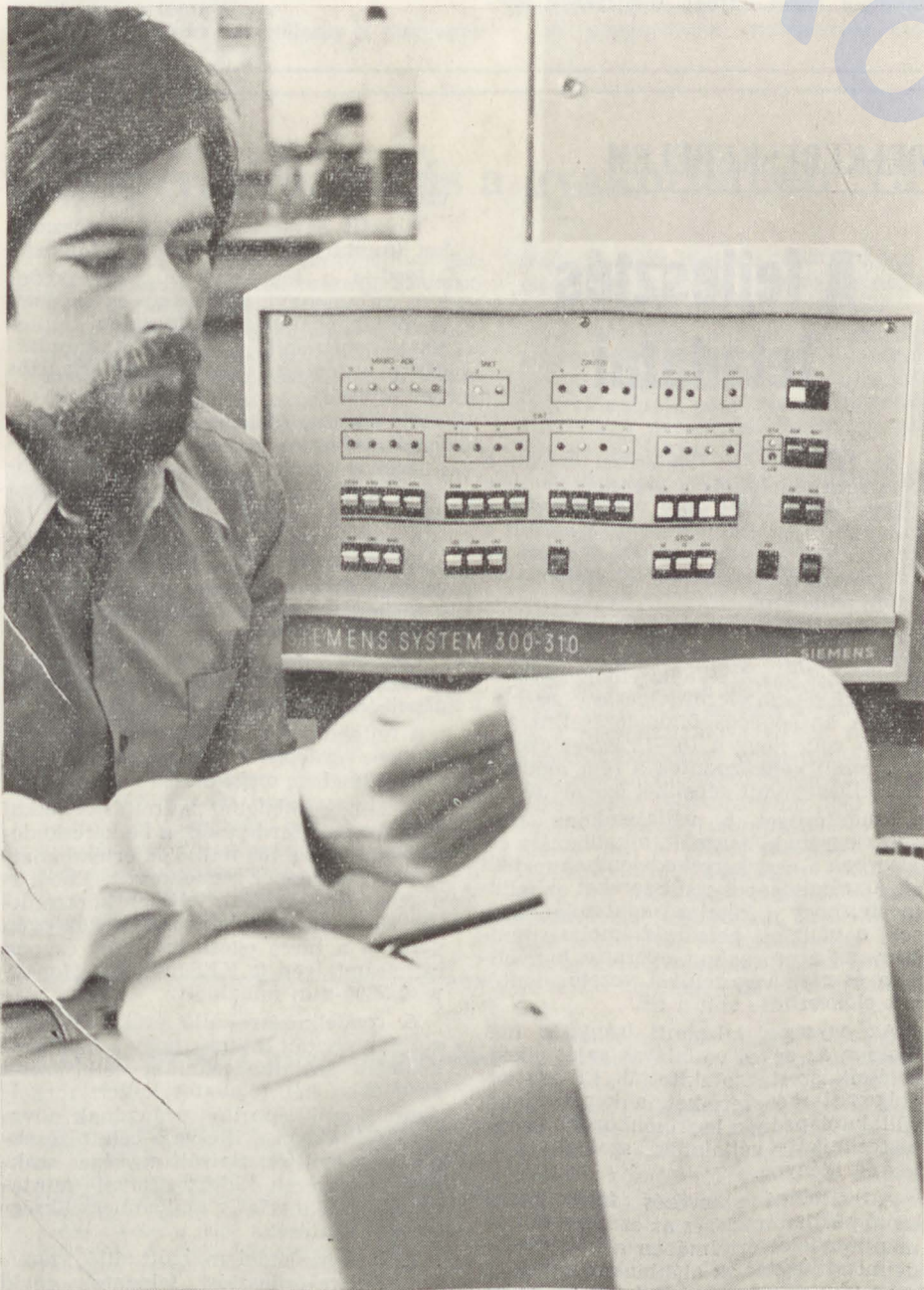
A Siemens bemutatta 810-es típusú folyamatszabályozó számítógéprendszerét, amelyhez — adott egyszerűbb vagy bonyolultabb szabályozástechnikai feladatok ellátására — megfelelő központi egységeket (310D és 310S) fejlesztettek ki.
