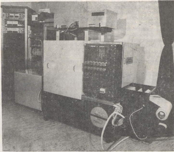
Az MTA SZTAKI lézernyomtató kísérleti modellje
