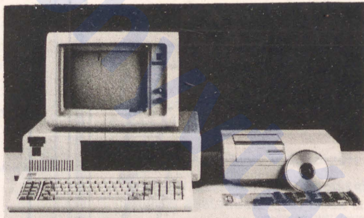
A Philips CM-100 CD ROM kompaktlemezes tárolója IBM PC-hez kapcsolva és a CM 155 CD ROM vezérlőegység. A kompaktlemez kapacitása 600 Mbajt.
